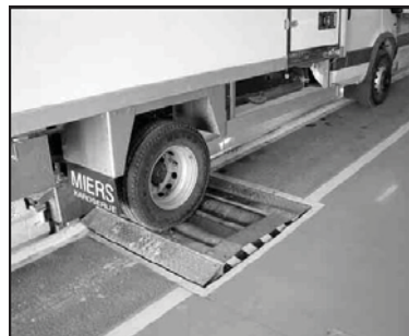
Sl. 8.39 Mjerenje kočione sile na točkovima zadnje osovine
