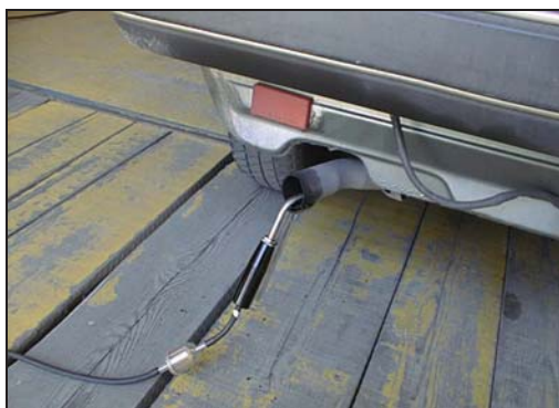
Sl. 8.65 Sonda za kontrolu izduvnih gasova kod benzinskih motora postavljena u izduvnu cijev vozila
