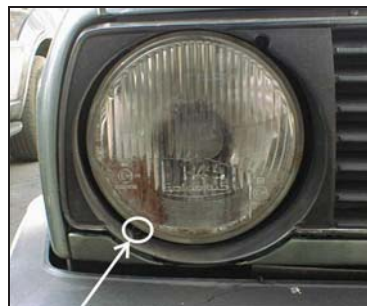
Sl. 8.53 Uređaj za visinsku regulaciju svjetala – uz pomoć vijka
