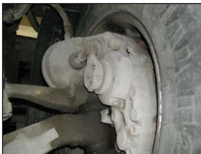
Sl. 8.22 Kočioni cilindar na točkovima prednje osovine, čeljust disk kočnice sa kočionom polugom
