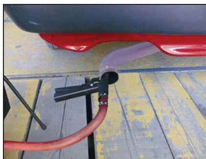
Sl. 8.67 Ispitna sonda za dizel motore postavljena u izduvnu cijev automobila
