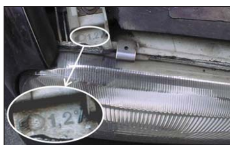
a) Znak pada snopa svjetlosti za oborena svjetla – vozilo marke Volkswagen tip Golf 3
