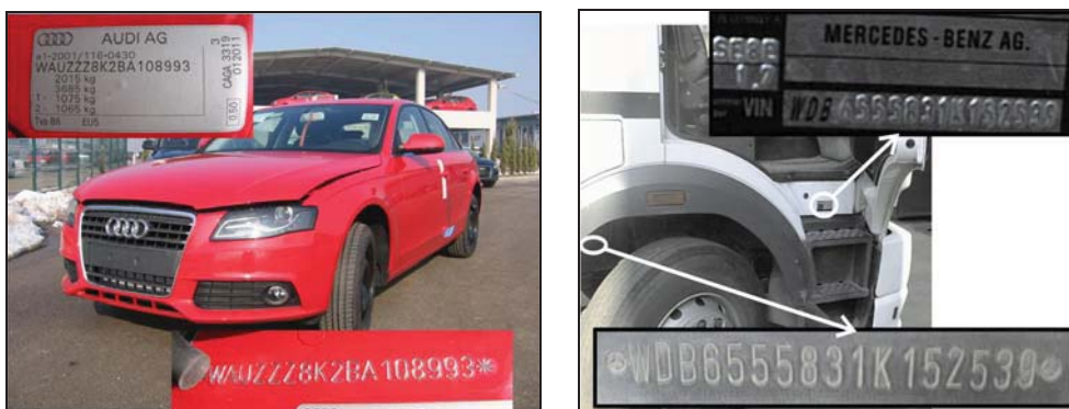
Sl. 8.6 VIN broj i pločica vozila kod putničkog vozila marke Audi i teretnog vozila Mercedes Benz 239/LSB8B
