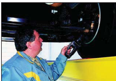
Sl. 8.13 Provjera zazora korištenjem razvlačnice
