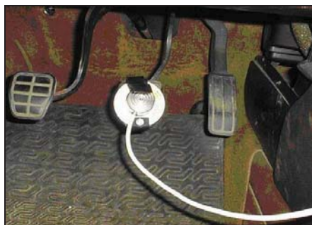
Sl. 8.46 Postavljanje dinamometra za mjerenje sile na pedali kočnice (Maha VZM 100)
