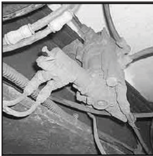
Sl. 8.27 Pneumatski upravljani ARSK ventil
