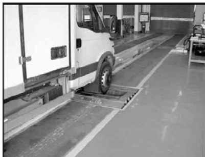
Sl. 8.38 Mjerenje kočione sile na točkovima prednje osovine
