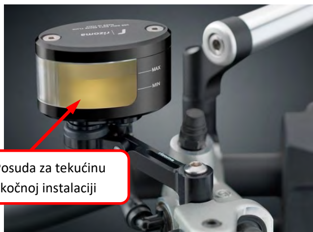
Slika 7.5. Primjeri izvedbi posuda za tekućinu u kočnoj instalaciji
