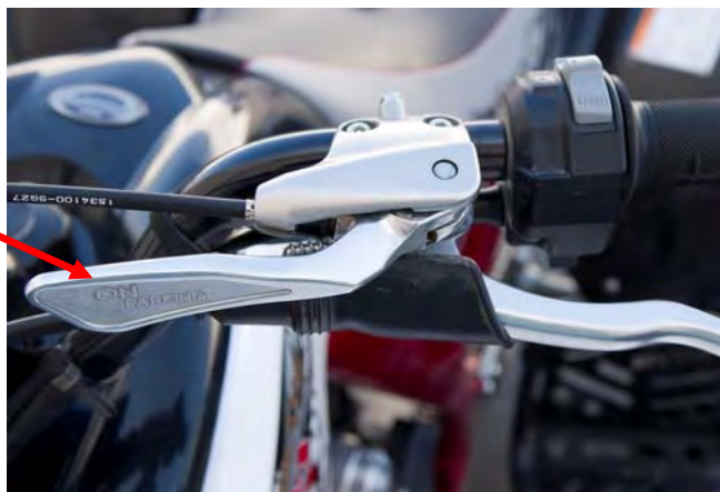
Slika 6.8. Primjer upravljačke komande uređaja za parkirno kočenje
