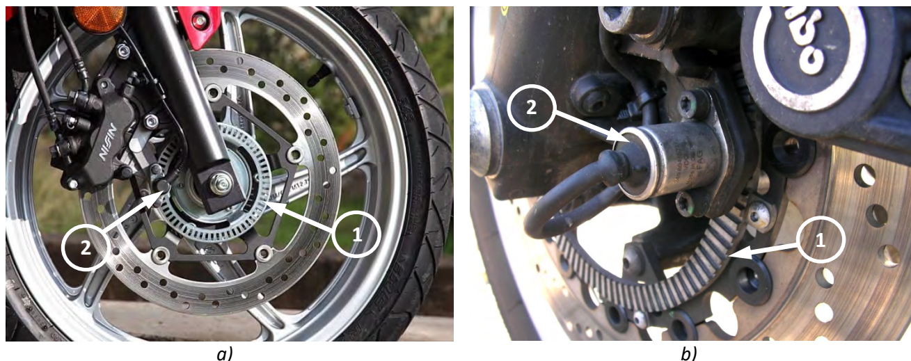
Slika 7.7. Uređaj protiv blokiranja točkova – ABS: nazubljeni vijenac (1) i senzor ugaone brzine (2)
