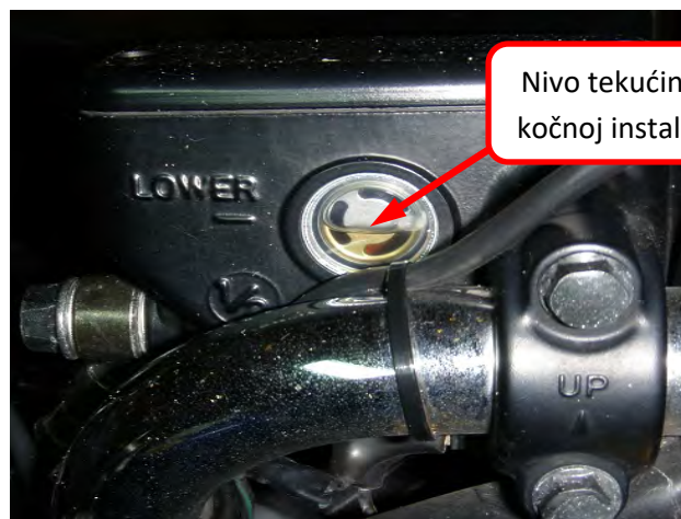
Slika 7.5. Primjeri izvedbi posuda za tekućinu u kočnoj instalaciji
